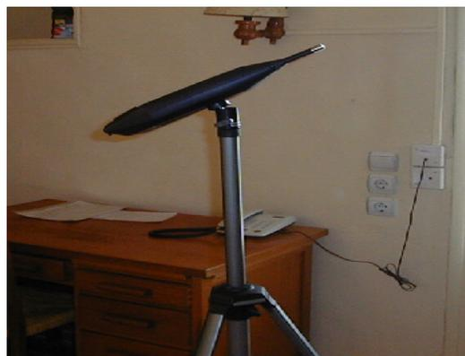
Figure 5 : Mesure du niveau du bruit à l'intérieur
