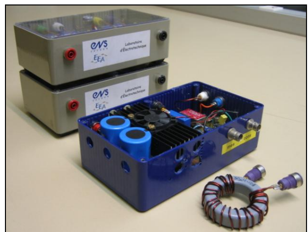
Fig.9 : Vue d'ensemble du hacheur, de l'inductance de "lissage" et des deux boîtes de six supercondensateurs.
