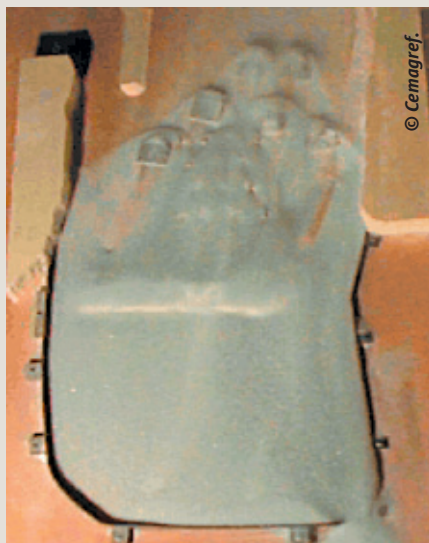
7 Dépôts obtenus par les expériences en modèle réduit (gauche) et par la modélisation numérique (bas)
