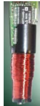
bobine d'induction et électronique embarquée [12]
