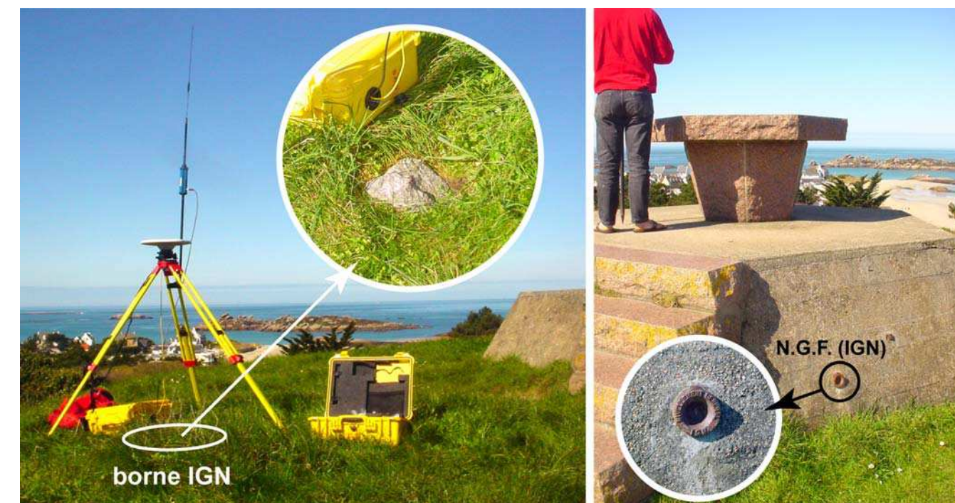
Photo 5 – Borne en granite et repère de nivellement en laiton de l'IGN situés au niveau de la table d'orientation sur la commune de Trégastel, et utilisés pour le géoréférencement des levés topo-morphologiques – (clichés Suanez et Fichaut 30/03/2009)
