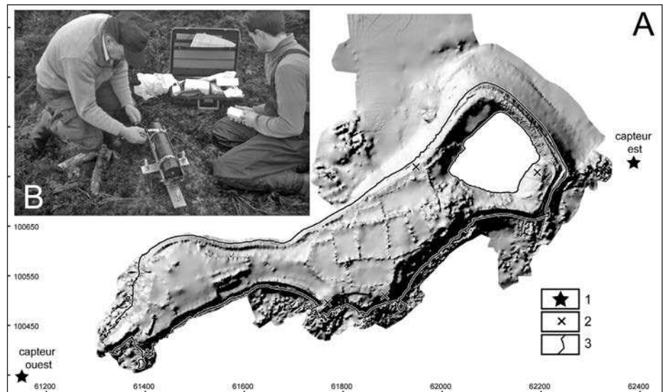
Fig. 9 – Localisation des capteurs de pression (A) ayant servi à mesurer les caractéristiques de la houle à la côte de part et d'autre de l'île de Trielen entre les mois de janvier et juin 2009. B : Installation d'un capteur de pression de marque Ocean Sensors dans la zone intertidale. 1 : capteur de pression ; 2 : point de calage géodésique (IGN) ; 3 : niveau des PMVE (3,5 m NGF).
