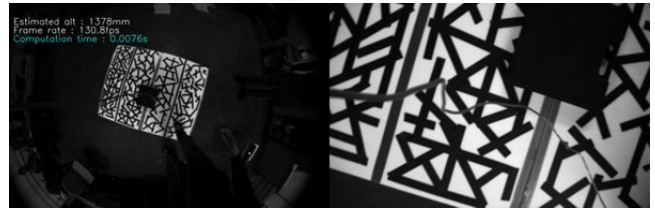
Fig. 7. Embedded view of UAV - Est. altitude 1378mm
