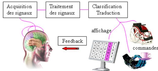
Figure 1 – Structure d'une interface cerveau-ordinateur.
