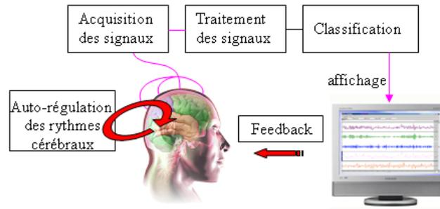
Figure 2 – Structure d'un système neurofeedback.
