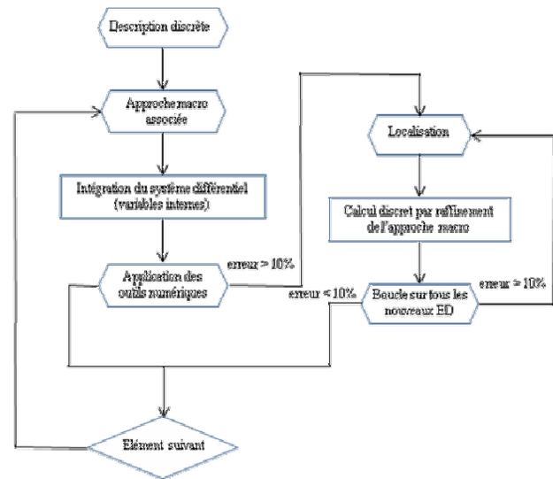
Figure3 : Algorithme de l'approche couplée
