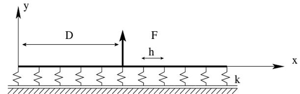
Figure1 : Modèle de poutre 1D hyper élastique.
