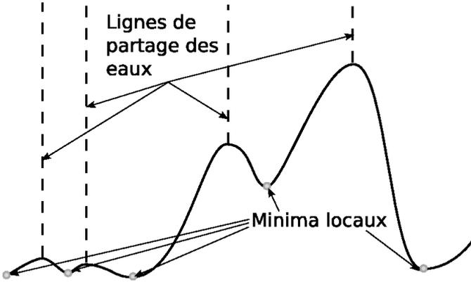
Figure 1: Exemple de coupe d'image d'élévation immergée.
