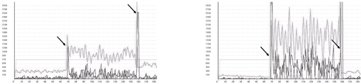
Figure 12. Évolution temporelle des mesures  $d$  (en vert),  $d'$  (en rouge), et  $d'_{\text{cumul}}$  (en bleu) pour une séquence contenant des transitions brusques indiquées par les flèches, en se basant sur l'espace TSL (à gauche) ou RVB (à droite).
