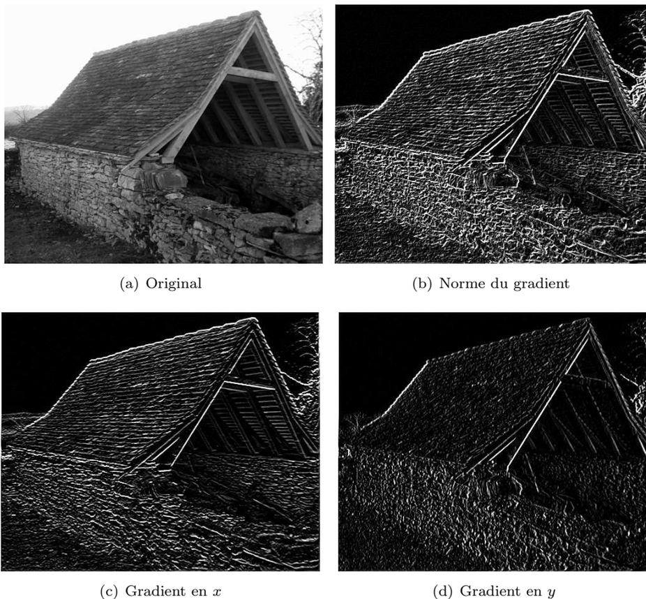
FIGURE 13. Détection de contours par une convolution de type Sobel
