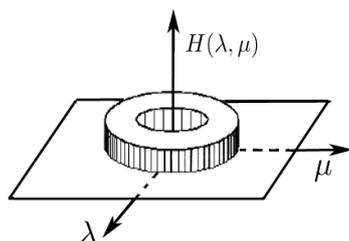
FIGURE 9. Fonction de transfert d'un filtre passe-bande « idéal »
