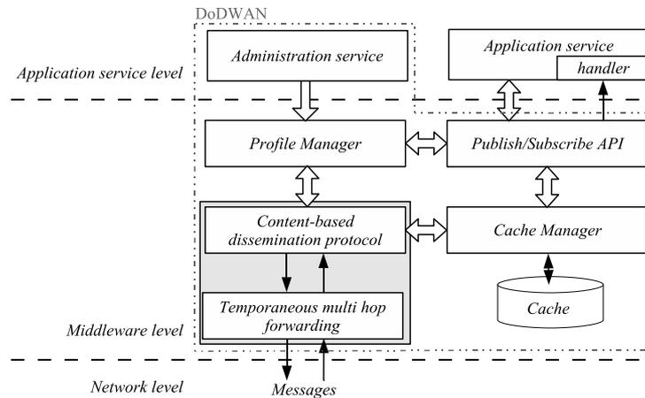
**Figure 2.** Architecture générale de la plate-forme intergicielle implémentant notre protocole de communication basée contenus
