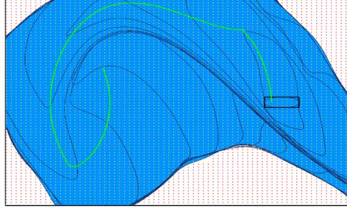
FIG. 3 – Approximation du bassin de capture du problème de la voiture sur la colline. L’axe horizontal représente la position  $x(t)$  et l’axe vertical la vitesse  $x'(t)$ .  $K$  est le rectangle qui limite les points de la grille. Le bassin de capture est représenté en bleu. Les différentes lignes de niveaux représentent les contours de la fonction valeur approchée. La grille contient 71 points par dimension.
