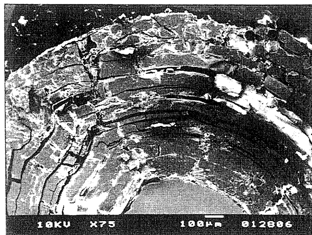
Figure 1 : Coupe métallographique transversale d'une épingle de l'Age du Bronze, exhumée d'une tombe. Observation en microscopie électronique à balayage : le noyau métallique en clair est entouré par une patine épaisse conservant la forme de l'objet, composée de strates de produits de corrosion ayant subi une très forte décuprification.
