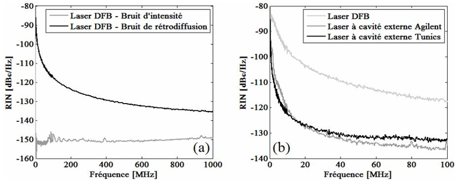
Fig. 2 : Spectres de bruit d'intensité et de rétrodiffusion de Rayleigh d'un laser DFB (a) et comparaison de spectres de bruit de rétrodiffusion de Rayleigh entre différents types de laser (b)
