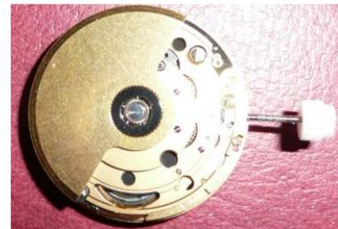
Figure 3 : Photo du système Autoquartz côté masselotte
