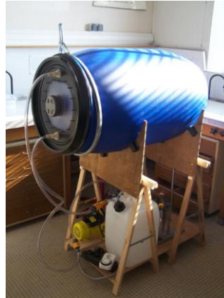
Encart 3 : machine à former et à rincer, pression du fluide circulant 3 bars: en mode dit de «fixation» la détente via les nébulisateurs assure la vaporisation du formol en vase clos
