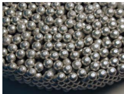
Figure 1 – Un des échantillons utilisés pour l'observation de la localisation d'Anderson des ondes élastiques. Il est composé de billes d'aluminium de 4 mm de diamètre, brasées pour former un réseau élastique désordonné.
