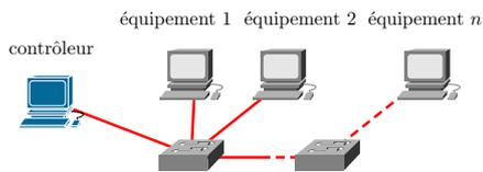
Fig. 7. Topologie linéaire commutée d'EtherNet/IP
