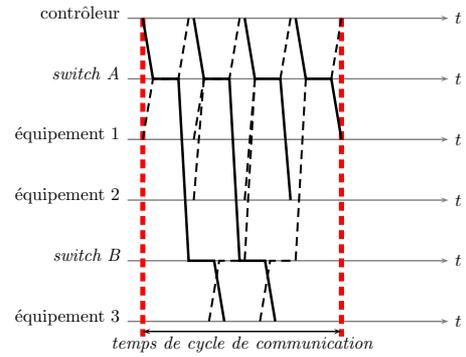
Fig. 8. Diagramme spatio-temporel d'EtherNet/IP avec des switches 4 ports
