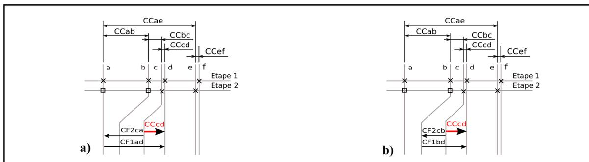
FIG. 5 – Détermination des chaînes minimales de cotes
