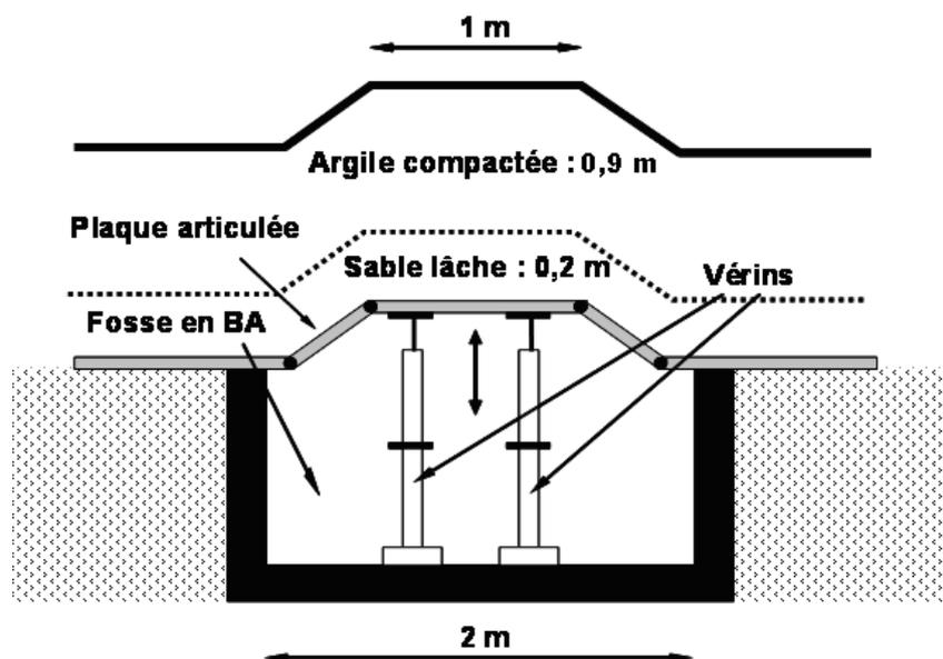
**Figure 1.** Essai de soulèvement d'une couverture d'une ISD
