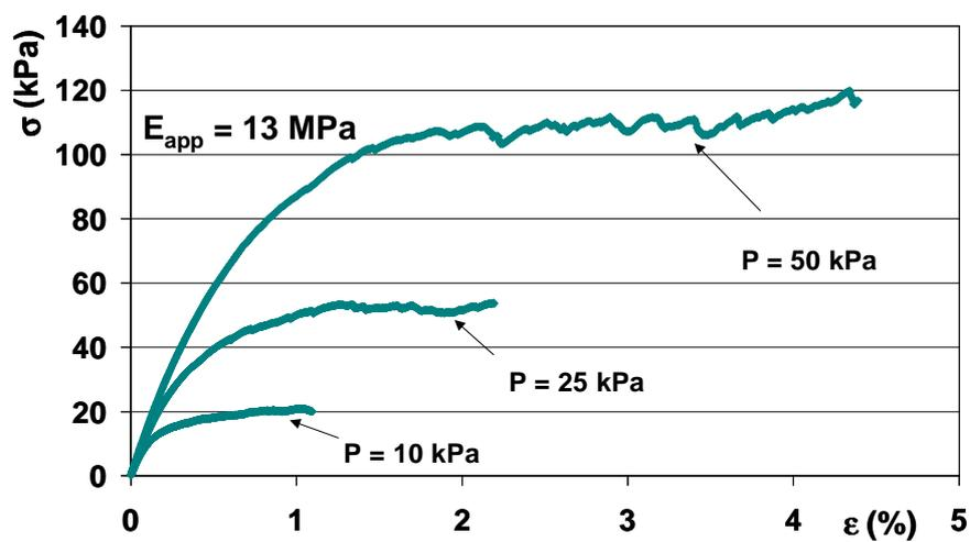
**Figure 6.** Simulation d'essais biaxiaux sur sable lâche
