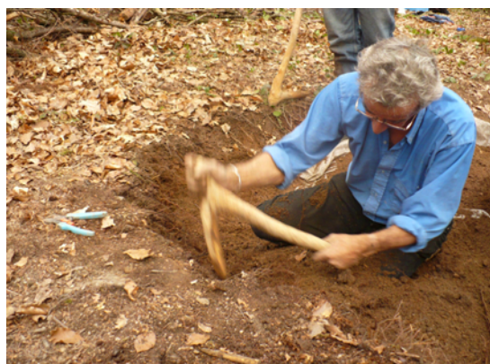
Figure 65 : pioche en bois à manche court en tenant la tête de la main droite (creusement 2, pioche 5)
