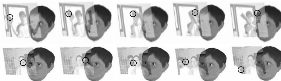
Figure 4: Exemples de scrutation de scènes naturelles par notre ACA. Pour les besoins de l'illustration, l'image ambiante acquise par la caméra de champ est incrustée dans un écran semi-transparent. Un cercle noir matérialise le point d'intérêt déterminé par notre système de gestion du regard. Les résultats sont donnés pour quelques images-clés de deux vidéos : en haut, le sujet agite un livre bleu en face de l'ACA et le module responsable de la poursuite d'objets contrôle le regard ; en bas, une personne va passer derrière l'interlocuteur, provoquant une saccade pour suivre ce nouvel objet d'intérêt.
