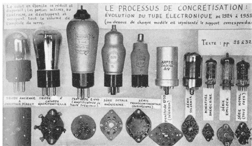
Fig. 1. Du mode d'existence des objets techniques, pl. iv (détail). Le processus de concrétisation du tube électronique (1924-1952).
