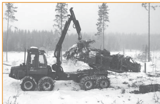
► Figure 12 – Fagoteuse FIBERPAC 370B en action et empilage de fagots, stockés à côté des billons (source Timberjack).
