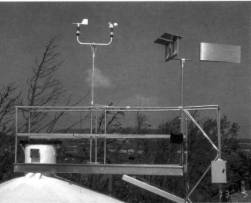
▲ Photo 1. - Intercepteur de flux pollinique et station météorologique associée (photo Cemagref, B. Besselat)
