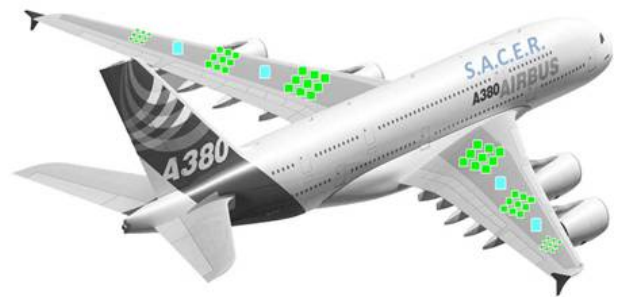
FIGURE 1. Exemple de réseau de capteur pour la mesure en vol du profil de pression d'une aile
