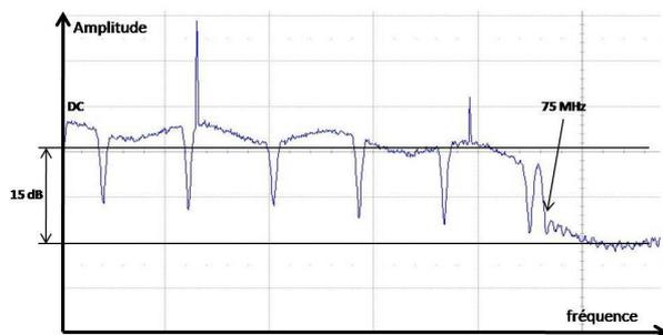
FIGURE 9. Spectre bande de base de sortie de l'émetteur
