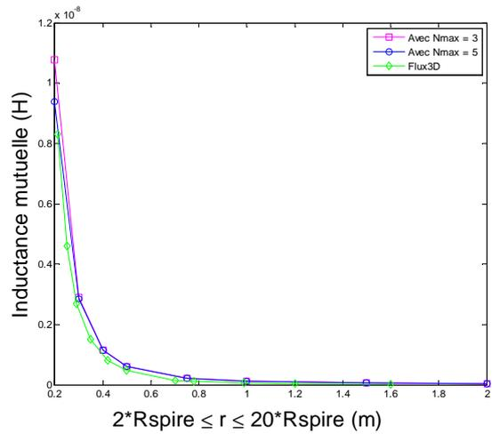
Fig.11 – Comparaison de l'inductance mutuelle entre deux boucles pas sur le même axe en fonction de la distance
