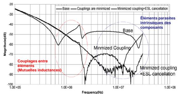
Fig.2 – Effet des éléments parasites dans un filtre [2].
