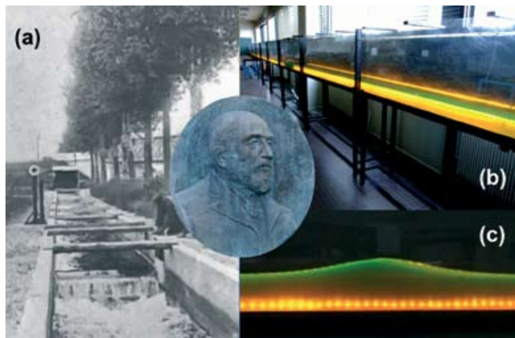
Fig 2. [a] Rigole du canal de Bourgogne dans laquelle Henri Bazin a pu mener ses expériences hydrodynamiques (en médaillon, Henri Bazin, tel que représenté sur la fontaine Bazin de la place Saint-Michel à Dijon). [b] Dispositif du département de Physique de l'Université de Bourgogne dans lequel on peut observer le profil traditionnel du soliton hydrodynamique [c].
