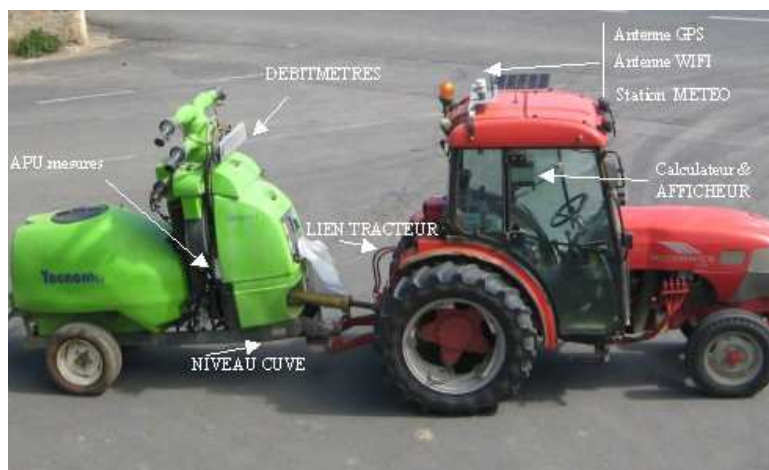
Figure 4: L'équipement tracteur - pulvérisateur. La MPU tracteur ( photo Cemagref)
