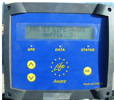
Figure 5: L'unité centrale MPU dans la cabine du tracteur
