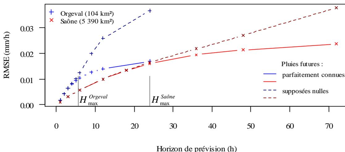
**Figure 5 : Evolution de l'erreur quadratique moyenne du modèle de prévision en fonction de l'horizon de prévision pour deux scénarios de pluie future différents (pluie nulle et pluie parfaitement connue). Le scénario de pluies futures n'a pas d'influence sur les performances du modèle jusqu'à un horizon de 6 heures pour le bassin rapide, jusqu'à un horizon de 24 heures pour le bassin plus lent.**
