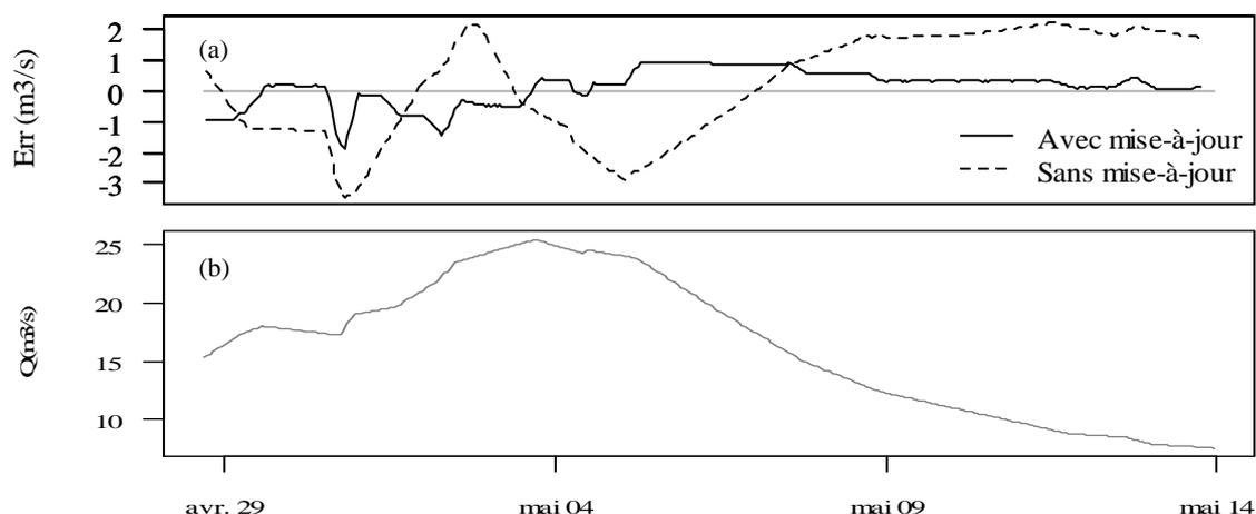
Figure 2 : (a) Comparaison des erreurs du modèle GR3P appliqué sans et avec mise à jour pour une prévision à 6 h et (b) débit observé sur le bassin versant de l'Yèvre à Savigny-en-Septaine (531 km<sup>2</sup>) pour la crue du 28 avril au 13 mai 1998. Les prévisions sont effectuées pour un horizon de 6 heures. L'erreur avec mise-à-jour est plus faible que sans mise-à-jour et est moins corrélée.
