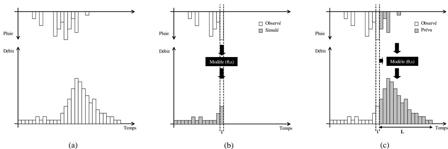
**Figure 1 : Illustration des différences entre simulation et prévision en modélisation hydrologique. (a) événement observé ; (b) application du mode simulation au pas de temps courant  $i$  ; (c) application du mode prévision au pas de temps courant  $i$  et pour un horizon  $H$ .**
