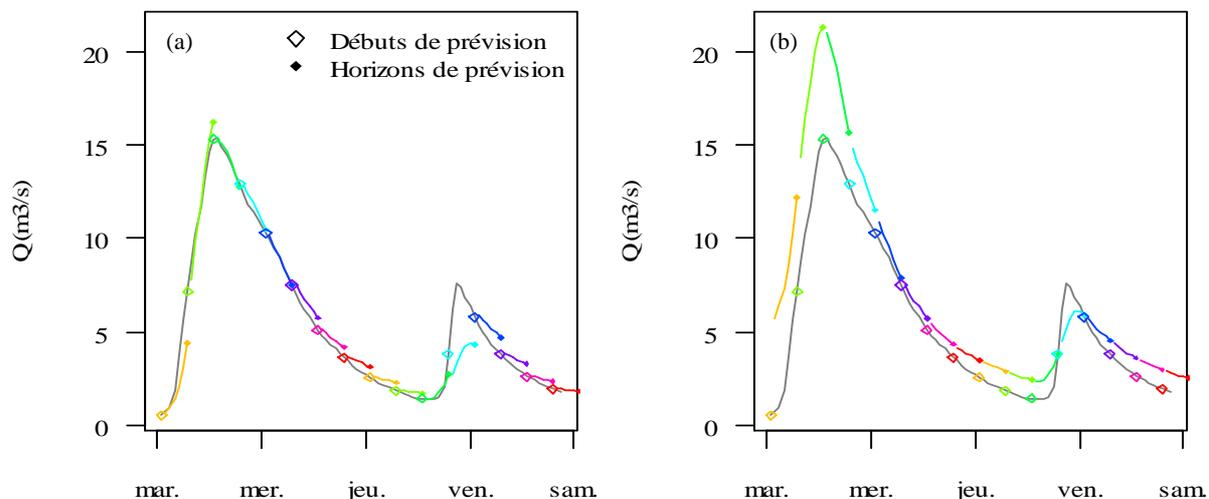
Figure 3. Exemple de prévision à 6 heures réalisée sur l'Orgeval avec le modèle GR3P avec (a) et sans (b) mise-à-jour du 19 mars au 22 mars 2002. La mise-à-jour permet d'améliorer nettement les prévisions sur les deux pics de crue.
