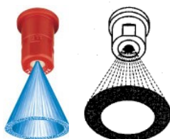
Figure 7 – Jet fourni par une buse à turbulence
