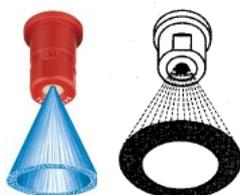
**Figure 7 – Jet fourni par une buse à turbulence**
