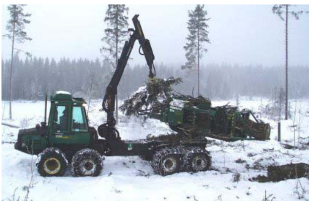
Figure 5 : Fagoteuse FIBERPAC 370B en action et empilage de fagots, stockés à côté des billons (source Timberjack).
