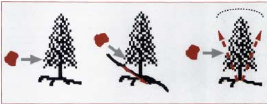
◀ Figure 3. – Effets d'un choc sur un arbre in situ (l'exemple d'un bloc)
