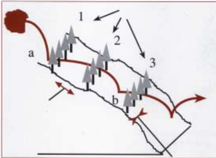
◀ Figure 4. – Principe théorique de la prise en compte de la végétation contre les chutes de rochers
