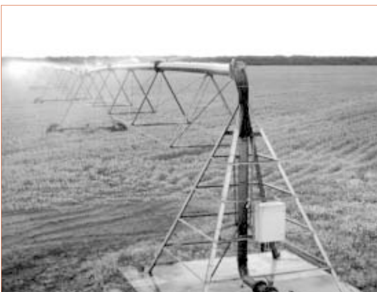
▲ Photo 1. – Vue d'un pivot d'irrigation. Au premier plan l'élément central ou point de pivot de l'appareil.
