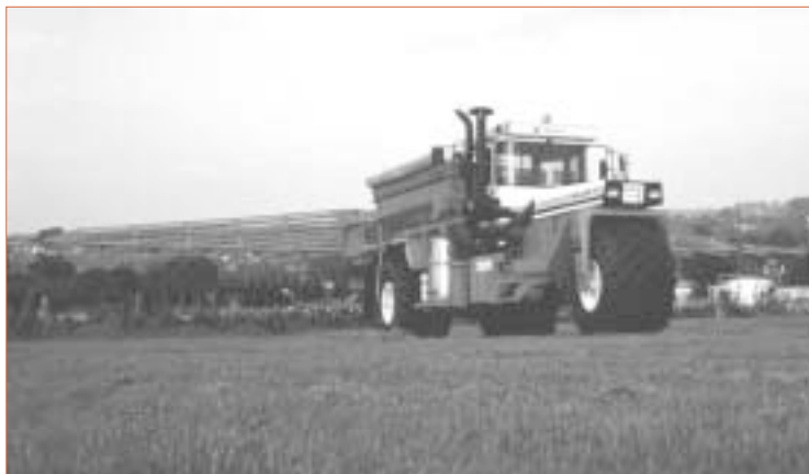
▲ Photo 4. – Automoteur d'épandage pneumatique utilisé aux USA pour la modulation intraparcellaire des apports d'engrais.
