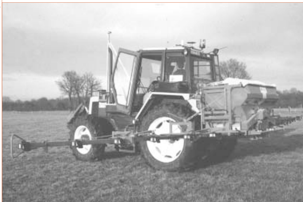
Photo 5. – Distributeur pneumatique adapté par le Cemagref pour la réalisation de cartes de fertilisation préprogrammées ; chaque demi-rampe de 6 m est commandable de façon indépendante.
