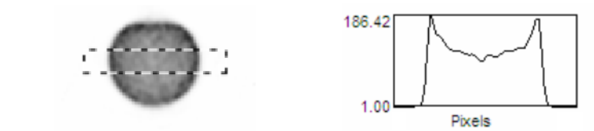
Figure 2: méthodologie choisie pour la détermination d'un coefficient objectif d'uniformité, A gauche l'image de la coupe homogène avec la ROI sélectionnée, et à droite le profil d'intensité des pixels, générée à partir de la ROI
