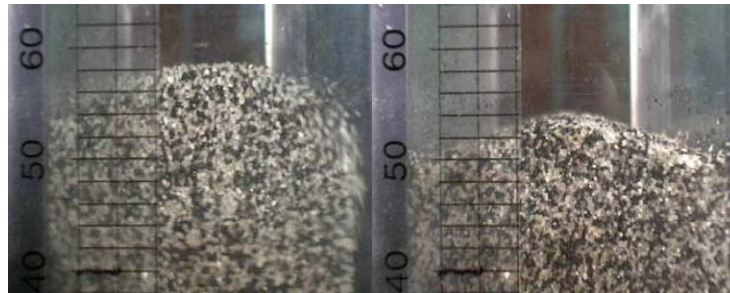
Figure 6. Vue de la face Est d'un empilement vibré à f=50 Hz et \Gamma=6 . (a) en vibration ; (b) relaxé
