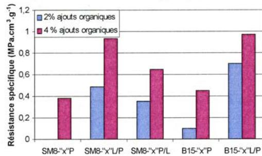
Figure 6. Résistance mécanique spécifique des comprimés élaborés conventionnellement
