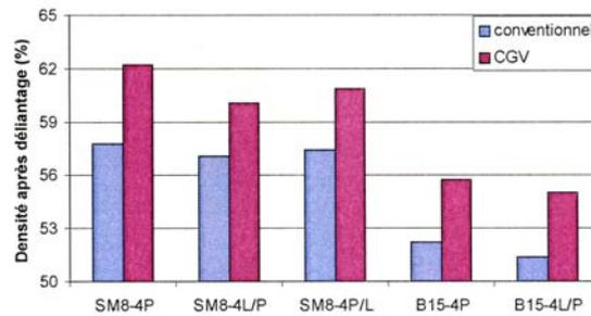
Figure 8. Densité après déliantage des comprimés conventionnels et CGV
