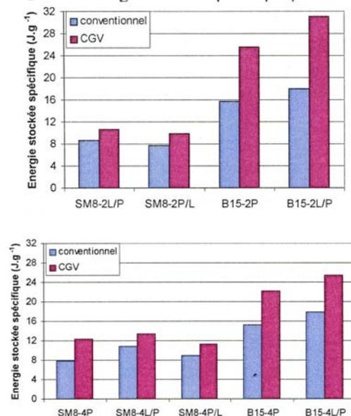
Figure 5. Energie stockée spécifique à 400 MPa pour chacune des poudres et des méthodes de mise en forme.
