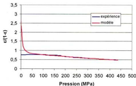
Figure 9. Illustration de la concordance entre données expérimentale et théorique du modèle de Lamy pour la poudre SM8-4L/P comprimée, (a) conventionnellement ; (b) CGV.
