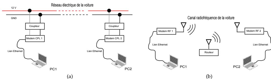
FIG. 3 – Schéma mesure PLC et RF.
