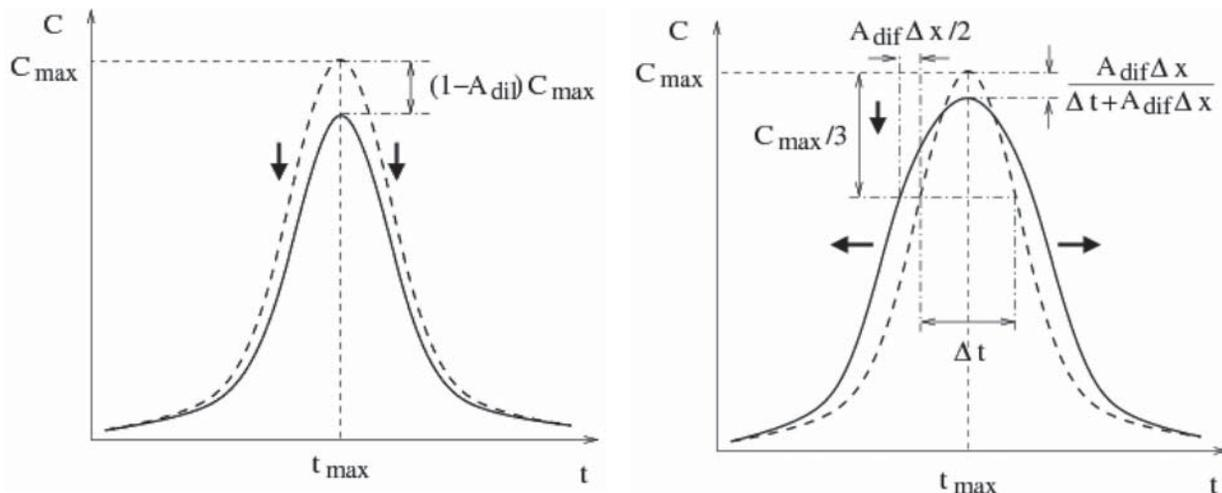
Figure 3 : Schématisation des effets de dilution (a) et de diffusion sur une distance  $\Delta x$  (b) pour un « nuage » de MES décrit par une fonction  $f(x, t)$  de maximum  $C_{max}$  et centrée sur  $t_{max}$ .
