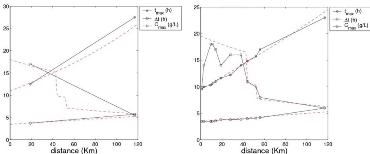
Figure 6 - Estimation des trois paramètres du modèle (symboles : d'après flux observés adimensionnalisés ; trait pointillé : modèle) pour les chasses de 2005 (a) et 2007 (b).
