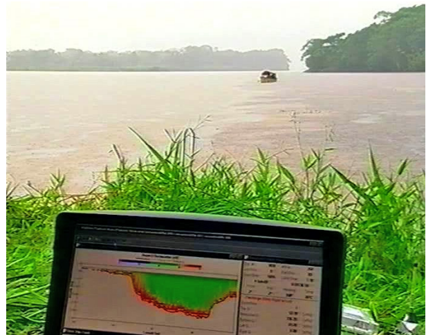
Figure 3 : jaugeage par aDcp en Amazonie (photo IRD)
