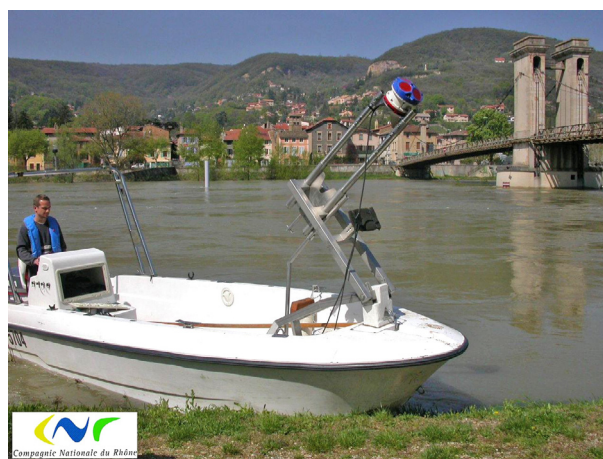
Figure 1 : bras articulé pour le déploiement d'un aDcp solidaire d'un bateau (photo CNR)
