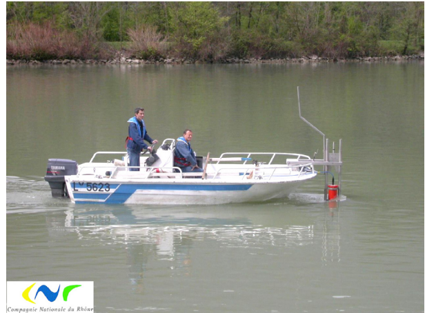
Figure III-3 : déploiement d'un aDcp solidaire d'un bateau (photo CNR)
