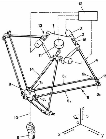
FIG. 1 - Structure DELTA selon le brevet de R. Clavel [1].
