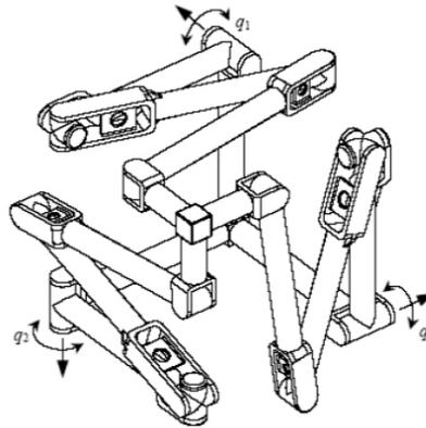
FIG. 3 - Manipulateur  $T_5/TPMs$  [5].
