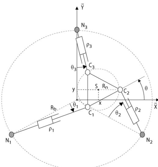
FIG. 5 - Robot parallèle plan 3-RPR.
