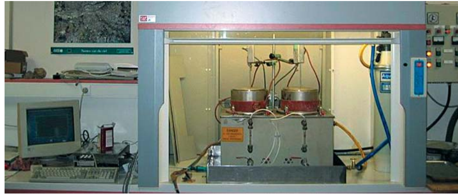
figure 2 Appareillage du test d'expansion à la vapeur.
