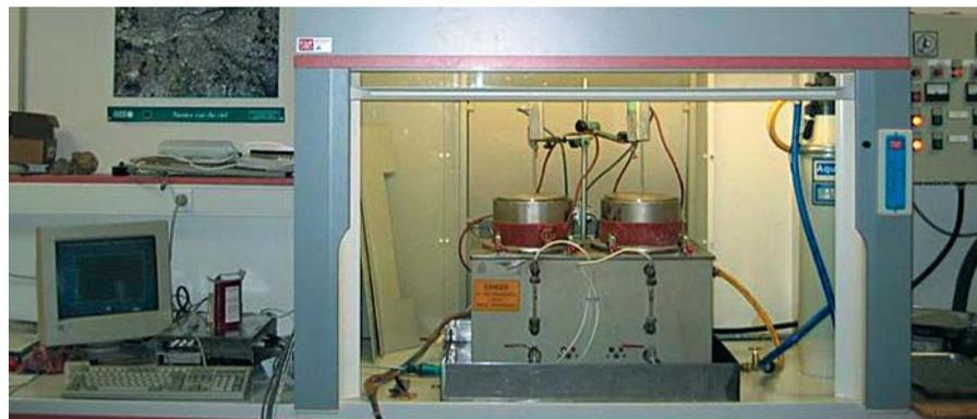
avec notamment sa teneur en chaux « libre », et son comportement vis-à-vis du test de gonflement à la vapeur (réalisés suivant le test européen d'expansion à la vapeur [7]).
