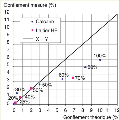
– lorsqu'on atteint le maximum de compacité avant maturation (ce qui correspond dans nos deux cas à 50 % de laitier LD), on change de comportement : les petits grains combler les interstices du squelette granulaire dominant, et la perméabilité est trop faible pour que la vapeur puisse irriguer l'ensemble du mélange. Elle ne va donc intéresser qu'une partie du volume, d'autant plus faible que l'on ajoutera encore du laitier LD. On retrouve alors le comportement prévu par la loi de mélange
