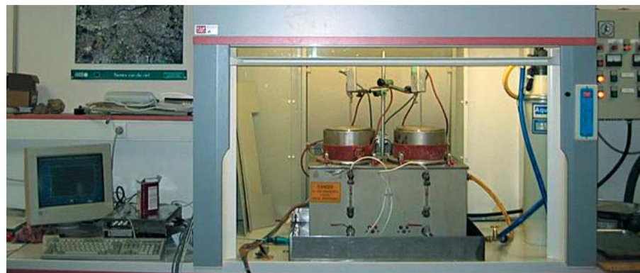
figure 2 Appareillage du test d'expansion à la vapeur.
